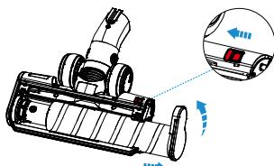
ボタンを持ち、反時計方向にエンドカバーを開き、ブラシローラーを引き出します。
