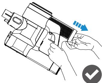
清掃する前に本製品の電源をオフにし、HEPA フィルタホリリースボタンを押しながら、外してください。（下向き）
