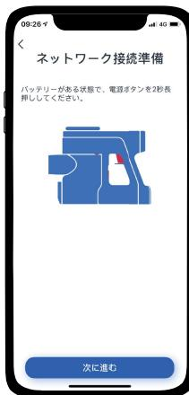
バッテリー電量が十分ある状態で、電源スイッチを2秒間長押しし、起動します。[リリース]ボタンを押し、ダストケースを取り外し、[WiFiリセット]ボタンを2秒間長押しし、接続を待ちます
