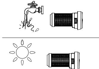
HEPA フィルタは必要な場合には流水で洗浄することができ、再度取り付ける前には完全に乾燥させてください。
