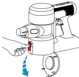
ダストケース側面の「ワンタッチゴミ捨てボタン」を押して、ダストケースふたを開いて、ダストを捨てる。
