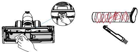
ブラシローラーを取り外し、ブラシと吸い込み口をやさしく掃除します。マルチ清掃ブラシによりローラーに巻き込まれた残留物を取り除いてください。
