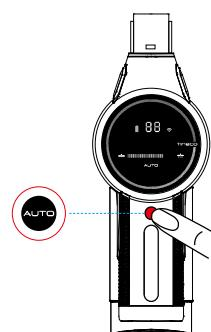
デフォルト設定で、起動後に、最初3秒で試運転を行い、パワーが若干強いです。異常が検出されない場合は、自動にAUTOモードになり、パワーがリアルタイムに反映します。
