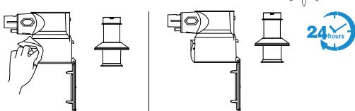
反時計回りに回転させ、フィルタを取り外します。
