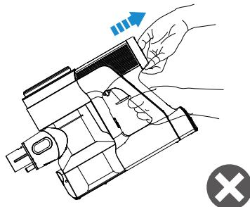
HEPAの取り出し及び取り付けの際には、図に示す間違った向きで取り付けてしまい、モーターの吸い込み口にごみが入り込まないように気を付けてください。
