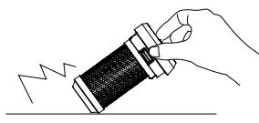
図に示すように平面で軽く叩くようにして、HEPA フィルタに付着しているちりを落としてください。
