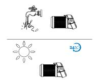
HEPAフィルタは流し水で洗浄可能。ただ、 取り付ける前に、完全に乾いていることを確 認する。
