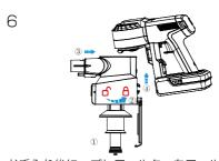
お手入れ後に、プレフィルターをフィルターホルダーに直接挿入し、それから、フィルターセットをダストケースに直接繋げて、時計回り方向に回してください。「カチッと」という音が聞えます。最後にダストケースカバーを閉じてください。
