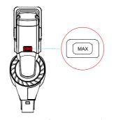
MAXモードボタンを押すたびに、 強・自動モードが切り替わる。
