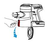
ダストケース側面の「ワンタッチゴミ捨て ボタン」を押して、ダストケースふたを開 いて、ダストを捨てる。
